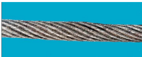
местное увеличение диаметра каната нарушение сердечника
